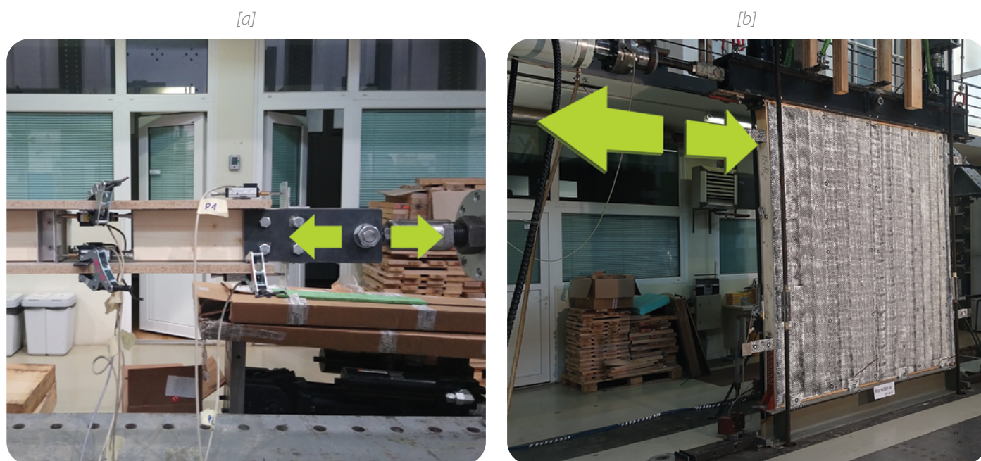
Slika 1 : Prikaz malega vzorca med preskušanjem [a] in stenskega panela dejanske velikosti [b].
